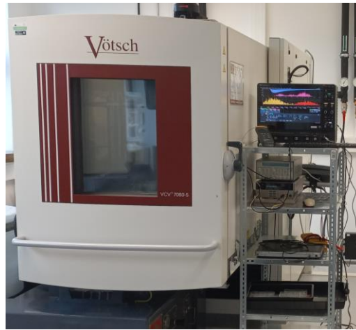
Şək.30 MSFD fotodiodun aşağı temperaturlarda parametrlərinin ölçülməsi üçün istifadə edilən qurğu.
