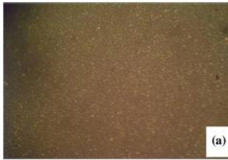
Şəkil13. CdS nazik təbəqələrinin səthinin ( \times 10^5 ) mikrofoto şəkli
