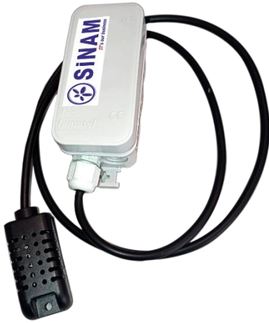
Temperatur və rütubət sensorunun prototipi
